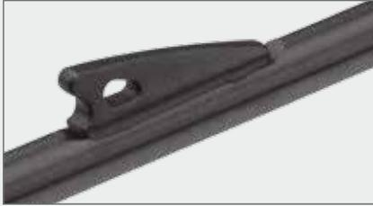
Asta INOX 17-4PH estremamente resistente e performante, pinnette realizzate in tecnologia M.I.M. - Metal Injection Molding - applicate con saldatura laser. Trattamento esterno di verniciatura ad alta temperatura per una migliore scorrevolezza. Nuova aletta a profilo scalato
