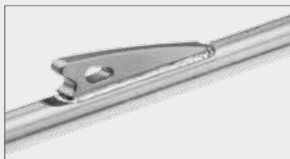
Asta in acciaio sandvik, pinnette realizzate in tecnologia M.I.M. - Metal Injection Molding - applicate con saldatura laser. Punta tricuspid per una perfetta perforazione
