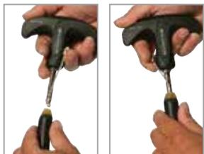
Multitool per assemblaggio ogive su elastico
